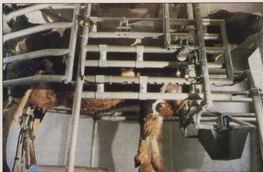
La traite en self-service, c'est possible avec le robot à quatre bras du Cemagref d'Antony.
